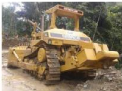
Fotografía 2 Equipo para descapote con tractor de hoja sobre orugas
