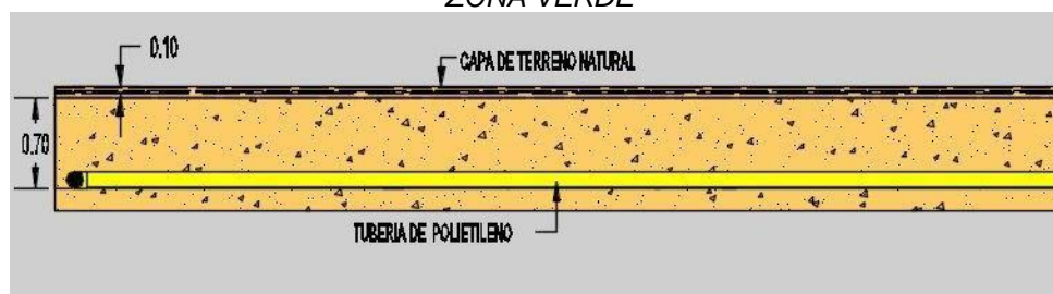
IMAGEN 1. CANALIZACIÓN DE TUBERÍA DE POLIETILENO DE 1/2", 3/4", 1" Y 2" EN ZONA VERDE
