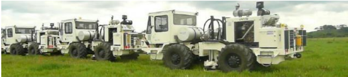
Fotografía 3. Set de Vibros Univib PSL326 Fuente: PETROSEISMIC SERVICES S.A
