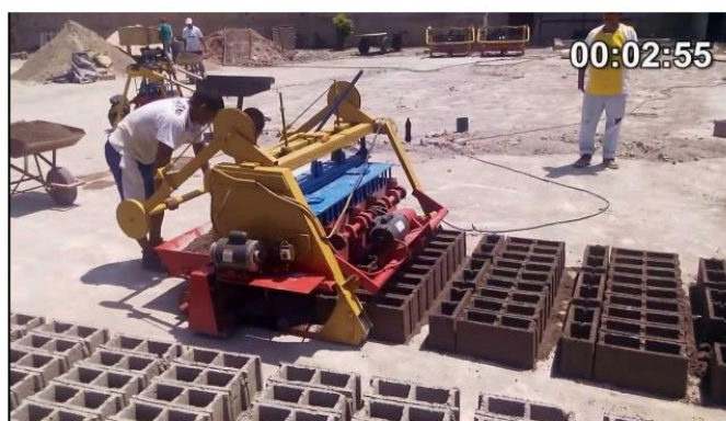
Figura 11. Descripción del uso de bloqueras semi automáticas propuestas para el proceso.
