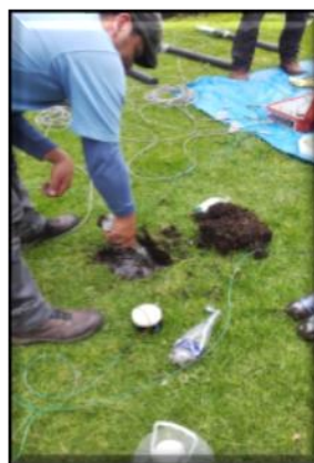
Figura 4. Realización de Hoyos para electrodos (10 cm de profundidad)
