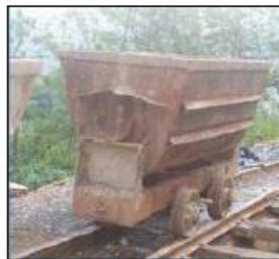
Figura 7. Vagoneta para transporte de mineral
