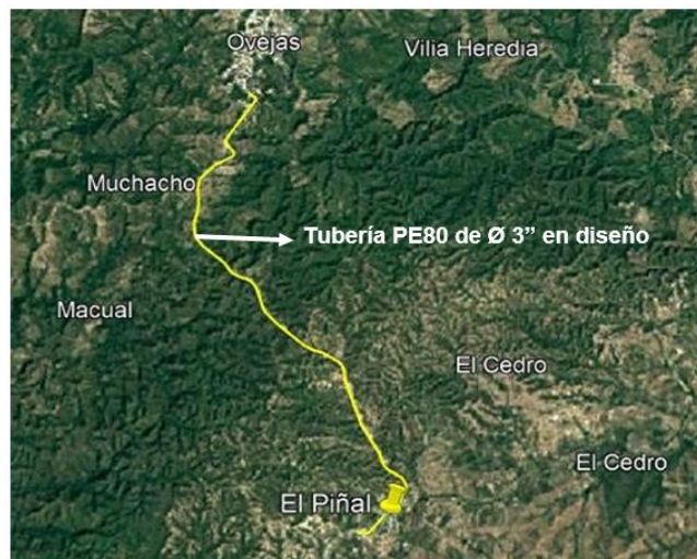
Imagen 1. Trazado línea de tubería en diseño PE80 de Ø3"
